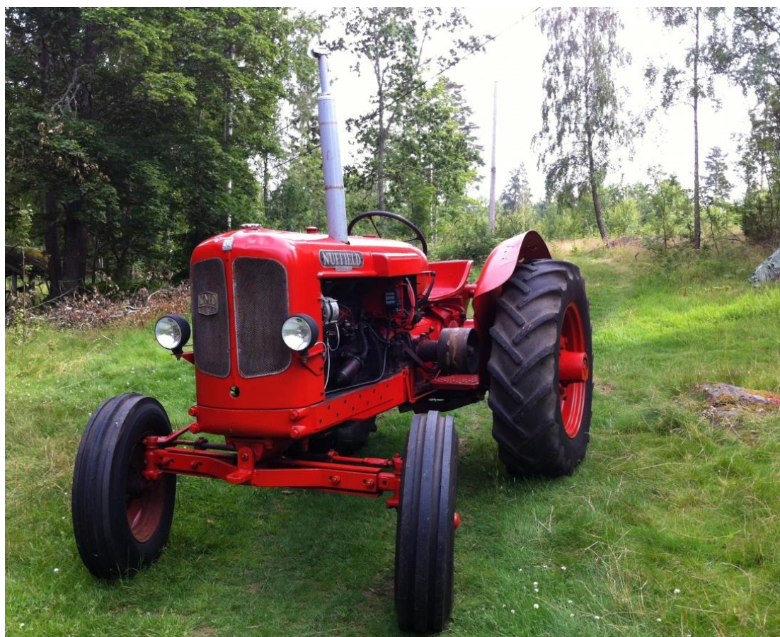
Nuffield 4DM. På kylarens framsida fanns ett hål för startvev. Bilderna är tagna från Google och godkända för kopiering.
